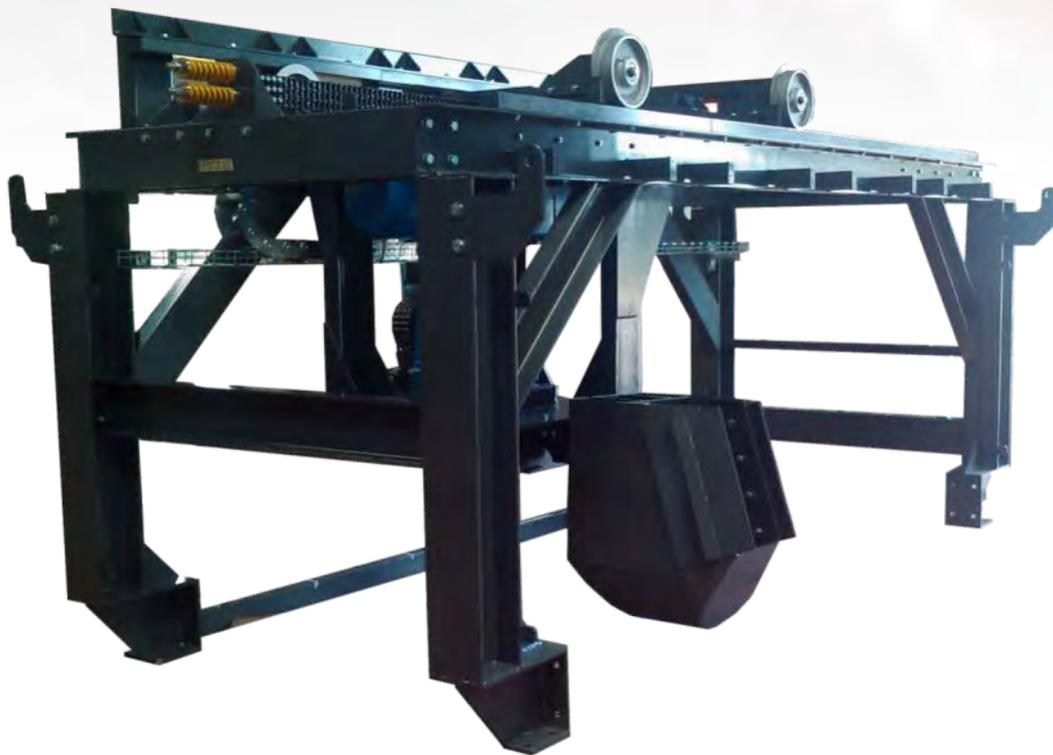
**MUESTREO EN DESCARGA DE BANDA TRANSPORTADORA**
